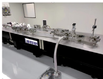
(鸞鸞:鸞鸞EUV光源与束线系统无缝集成,提供10-100 nm波长范围的高精度光束控制和输出,支持窄谱线EUV激光输出。)
